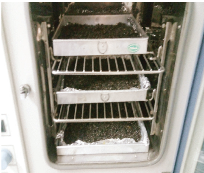
Gambar 3.1 Cara Pengeringan Biji Pepaya Dengan Menggunakan Oven mekanik Suhu 45°C selama 7 hari
